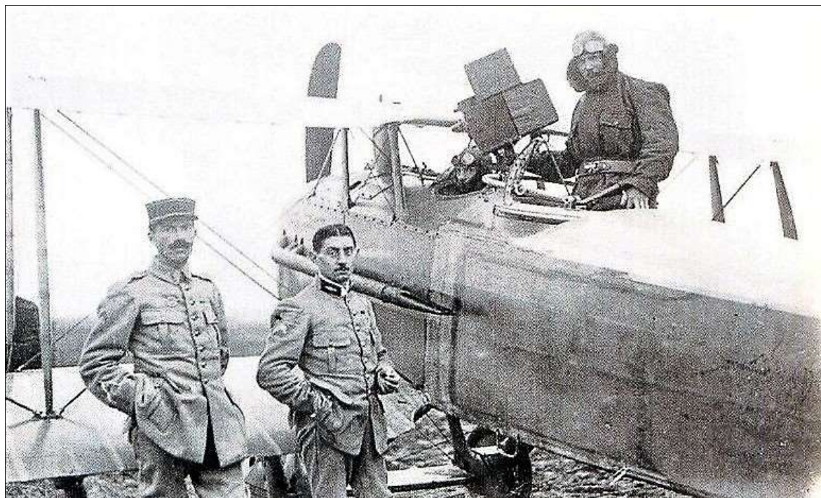
Appareil de photographie aérienne utilisé à partir de 1915. Cl. Musée de l'air et de l'espace
